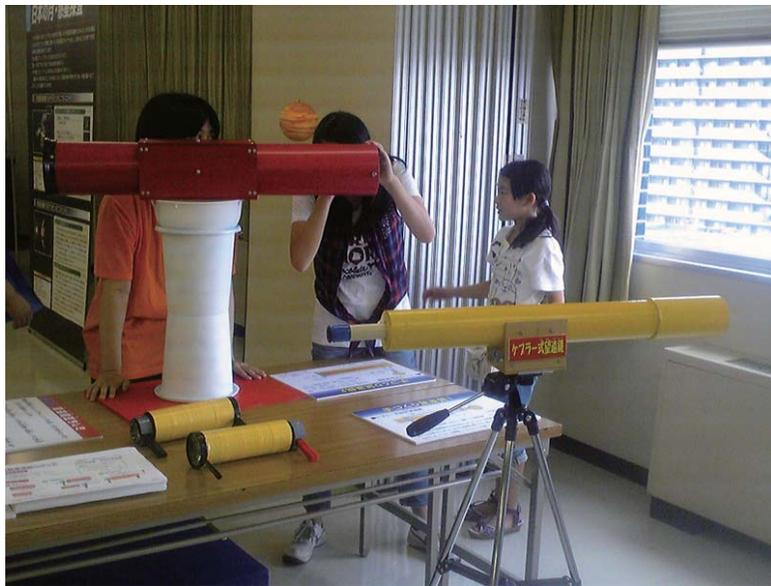
● 手作りのニュートン式（ドブソン式）反射望遠鏡（左）とケプラー式屈折望遠鏡
